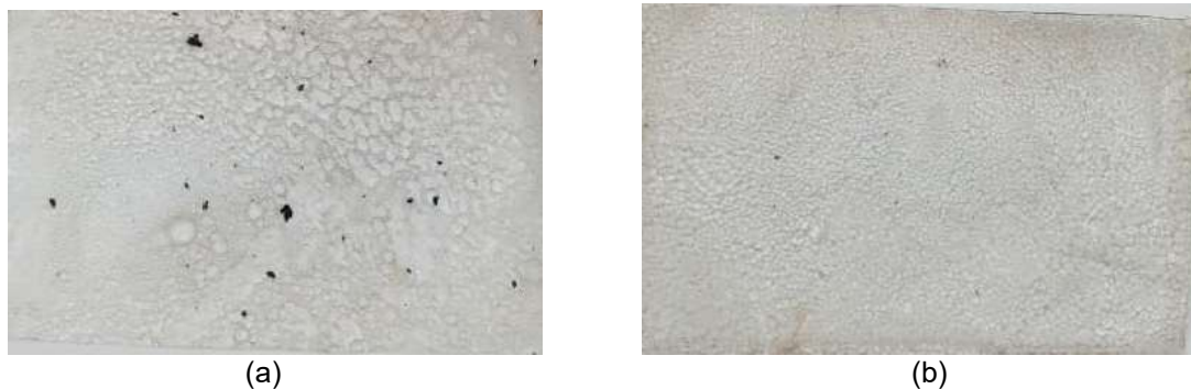
Gambar 1. Foto produk edible film dari pati sagu dengan (a) penambahan 0% CMC; (b) penambahan 15% CMC
